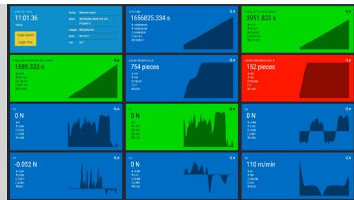
Um eine umfassende Echtzeitanalyse durchzuführen, stellt **weMonitor** das Oscilloscope bereit, welches unter anderem für die Fehlersuche und in der anschließenden Signalanalyse verwendet wird.
